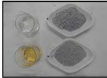
Figura IV-4.- Mezcla física del TRGO en la sílice.
