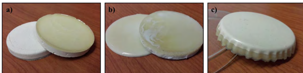
Figura IV-15.- Decantación de: a) BT_T ; b) BT_C ; c) SrT durante el proceso de curado.
