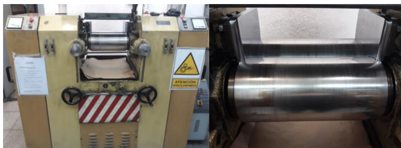
Figura 2.5. Imagen del mezclador de rodillos donde se llevó a cabo la dispersión de materiales grafénicos en silicona
