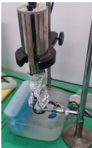
Figura 2.4. Imagen de la punta de sonicación empleada para dispersar los materiales grafénicos
