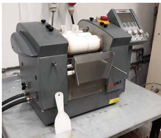
Figura 2.3. Imagen de la calandra, Exakt 80E, empleada en la dispersión de los materiales gráfénicos en las resinas
