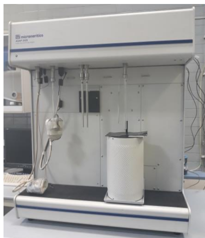
Figura 2.12. Imagen del equipo empleado en la adsorción física de N_2 de los materiales grafénicos sintetizados
