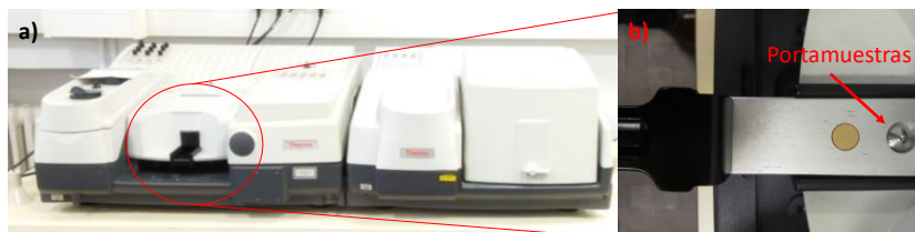
Figura 2.13. a) Espectrofotómetro con colector de reflectancia difusa y b) detalle del portamuestras
