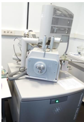
Figura 2.14. Imagen del microscopio electrónico de barrido (SEM) empleado en la caracterización de materiales grafénicos y materiales compuestos
