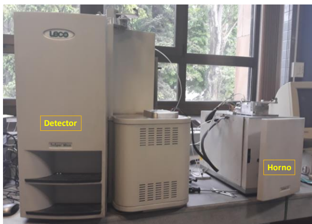
Figura 2.8. Equipo de análisis elemental para la cuantificación de C, N, H, S y O
