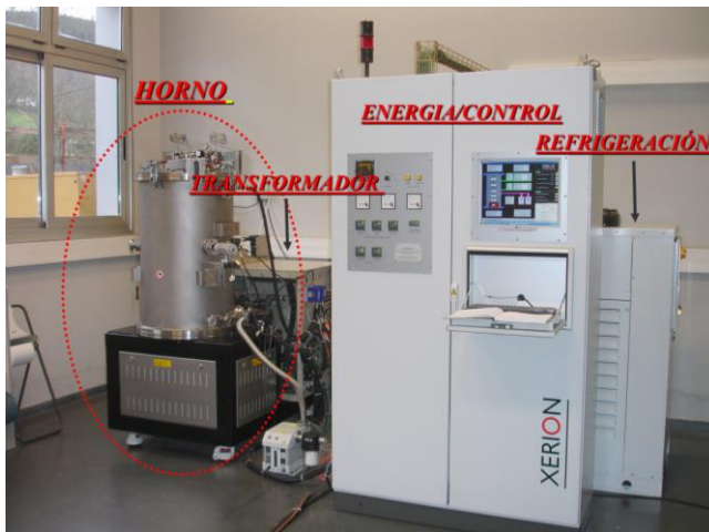
Figura 3.7. Imagen del horno de grafitización empleado en la obtención de materiales grafénicos reducidos a alta temperatura
