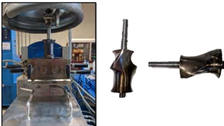
Figura 2.2 Fotografías de (izquierda) mezclador interno y (derecha) rotores tipo Banbury utilizados para la desvulcanización TM del GTR.
