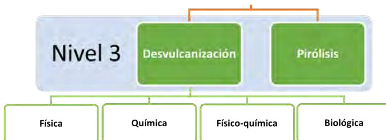
Figura 1.12 Desglose del nivel 3 del aprovechamiento de materiales del neumático.
