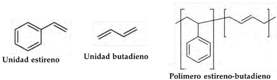
Figura 2.1 Estructura de las unidades estireno y butadieno y del caucho estireno-butadieno (SBR).
