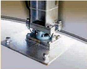
Células de carga **alimatic** precisión ±100 Kgs.
