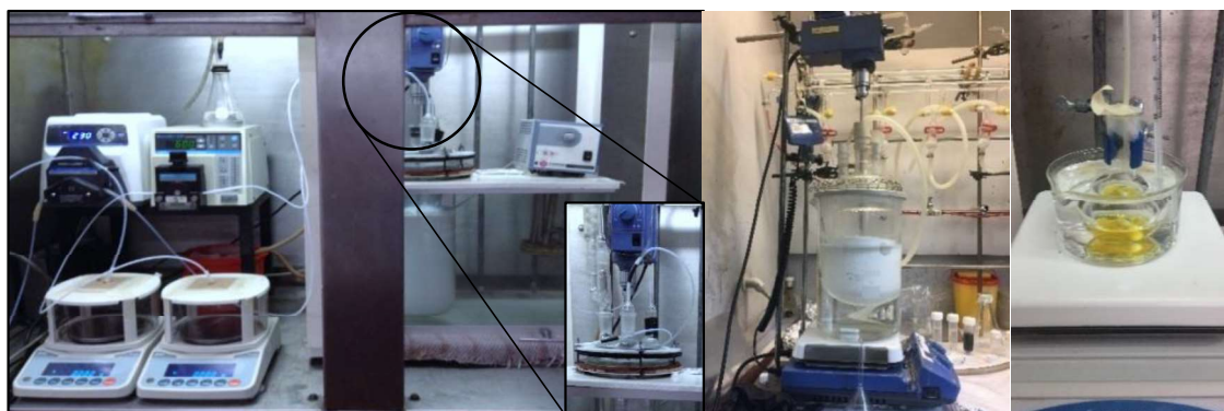
Figura 3.1. Arreglo del reactor de polimerización de (a) 4 L, (b) 1 L y (c) 50 mL, para la síntesis de copolímeros con gradiente de composición, (b) copolímeros de bloque y (c) copolímeros de bloque y copolímeros de gradiente.
