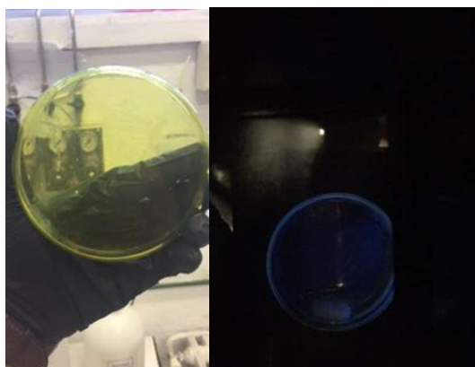
Figura 4.44. Copolímero tetrabloque BA/VK de composición global 50/50 % p/p (a) expuesto a luz común y (b) bajo una lámpara UV a 230 nm.
