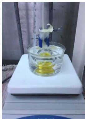
Figura 3.5. Reactor empleado en la síntesis del macro agente RAFT poli (ácido acrílico) 5 – b – poli (acrilato de butilo) 20 .
