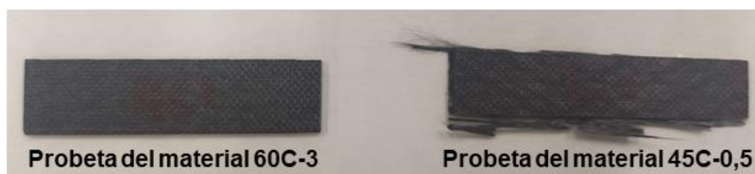
Figura 3.13. Probetas de laminados fabricados a distintas condiciones.
