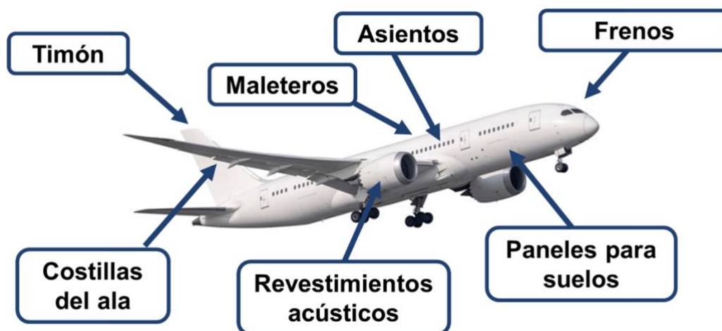
Figura 1.7. Ejemplos de FRP termoplásticos utilizados en aviones.
