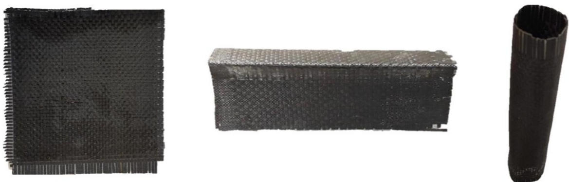
Figura 3.15. Laminados con Akelite termoconformados a 120 °C.
